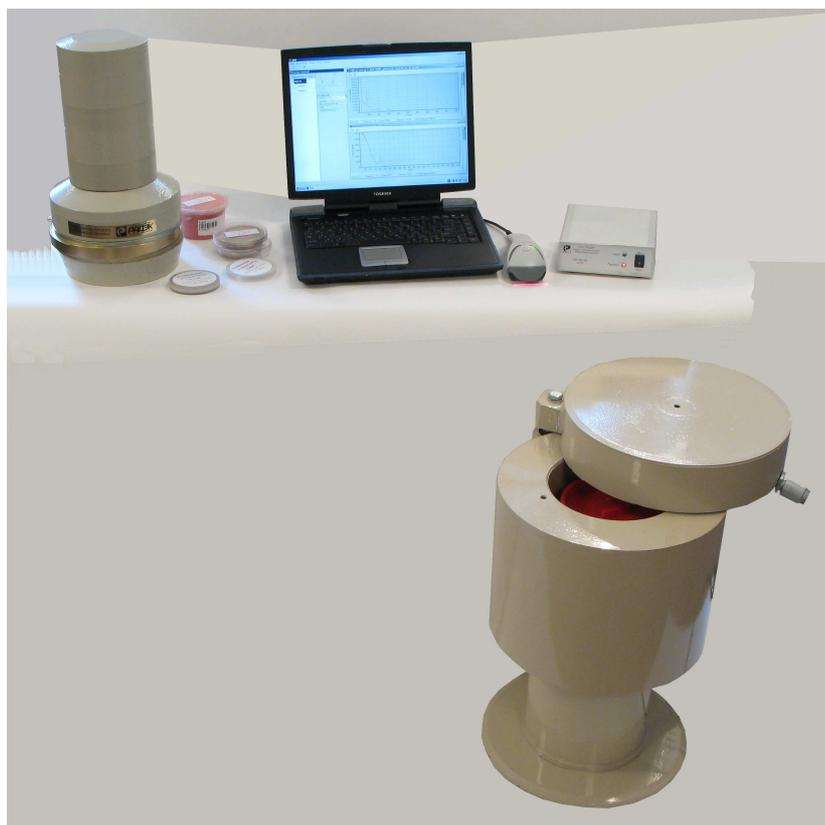
Минимально измеряемая активность определена для продолжительности измерения 1 час, объемном весе проб  $1 \text{ г} \cdot \text{см}^{-3}$ , объеме счетного образца  $1 \text{ дм}^3$  и относительной статистической погрешности 50% для доверительной вероятности 0,95.
