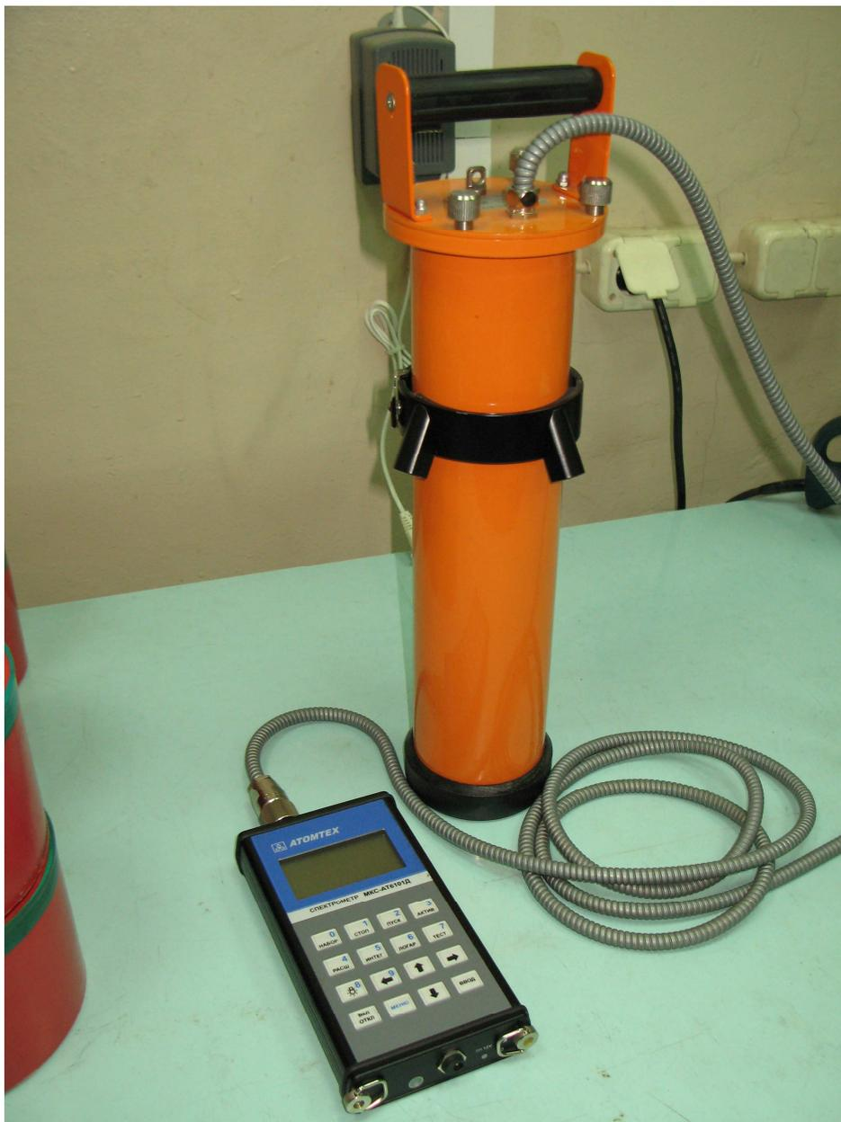
Переносной гамма-бета спектрометр «Прогресс-БГ (П)», производимый ООО НПП «Доза», по сравнению с МКС-АТ6101Д, имеет размер сцинтиллятора NaI(Tl)  $\varnothing 40 \times 50$  мм, более низкую чувствительность измерений и калиброван только в геометрии 4л ср.
